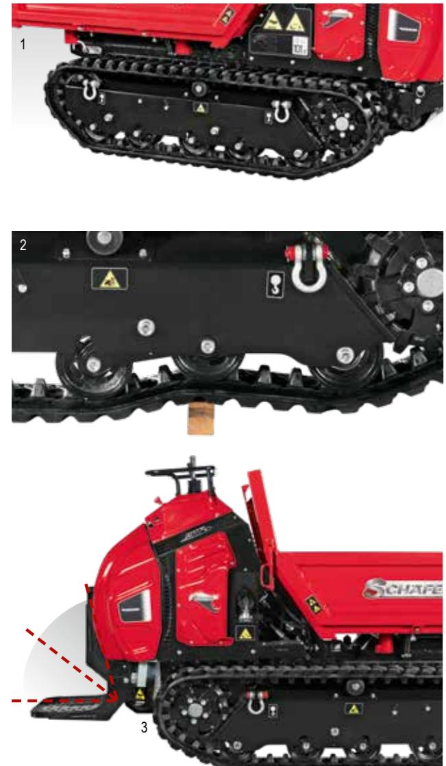
Die Mitfahrplattform kann für den Transport oder auf engen Baustellen einfach nach oben geklappt werden.
